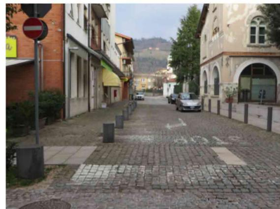
L'attraversamento pedonale di via Cumano non è conforme. Si rileva, inoltre, che il dislivello tra piazza e marciapiede viene compensato tramite tre gradini non segnalati con Loges.
