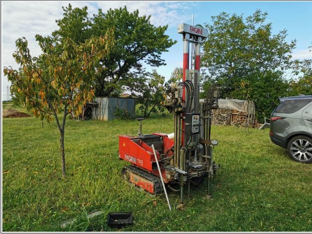
Prova penetrometrica dinamica superpesante DPSH 1
