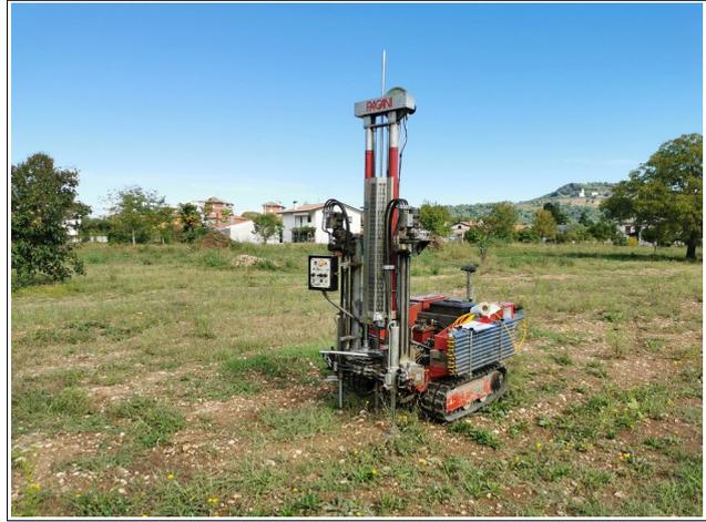
Prova penetrometrica dinamica superpesante DPSH 2
