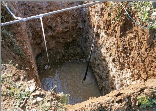
Prova di permeabilità in pozzetto
