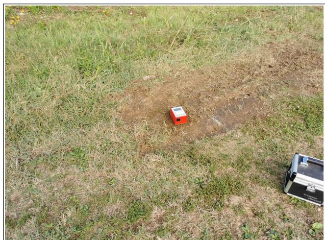
Indagine sismica passiva a stazione singola HVSr
